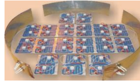
Heizung des Bodens durch Heizelemente und Wände durch Heizbänder
