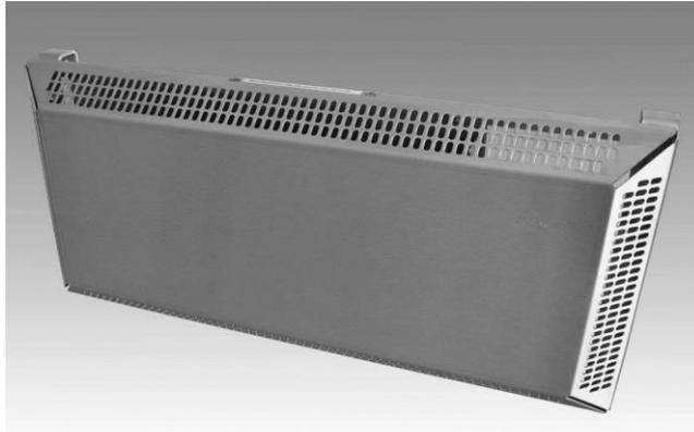
Lükon Panzerkonvektoren sind unverwüsthliche Direktheizgeräte aus Chromnickelstahlblech 1.4404. Sie werden in öffentlichen Anlagen wie Toiletten und Wartestationen, aber auch in feuchten Räumen, Schlachthäusern, Kläranlagen, Maschinenräumen usw. eingesetzt. Mit ihrer kombinierten Strahlungs- und Konvektionsheizung eignen sie sich zum Temperieren in der Übergangszeit wie auch zum durchgehenden Beheizen von exponierten Räumen.
